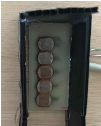
圖九、自製光敏電阻接收器
