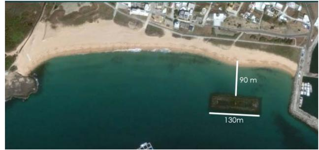
圖 12 山水沙灘東側離岸堤離岸距離與堤體寬度
