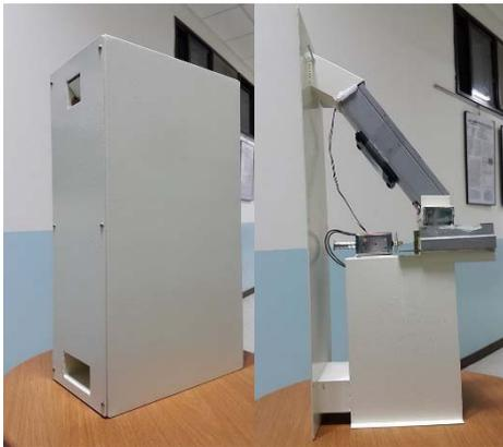
圖 3 鑰匙箱外觀及內部構造
