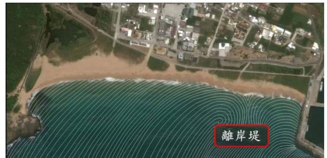
圖 13 沙灘東側外海的離岸堤造成波浪入射方向(如圖上白線)的改變，而使沉積物堆積於後方的沙灘
