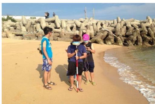
圖 3 研究人員持 Trimble R8 高精度 GPS 儀器測量沙灘地形
